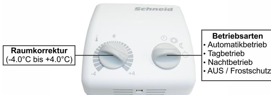
Für die Vorwahl der Betriebsart ist ein **AUTOMATIK / TAG / NACHT / AUS** Vorwahlschalter vorgesehen. Zur Veränderung der Raumsolltemperatur ist ein Einstellpoti mit einem Bereich von plus/minus vier Grad vorhanden. In der Fernbedienung ist ein Raumfühler eingebaut, der zur Anwendung verschiedener Heizungsregelprogramme und zur Optimierung des SCHNEID Regelgerätes herangezogen werden kann.
